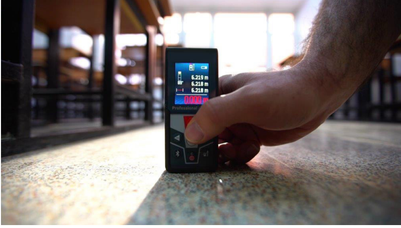
Şekil 7. Lazermetre ile Ölçüm
