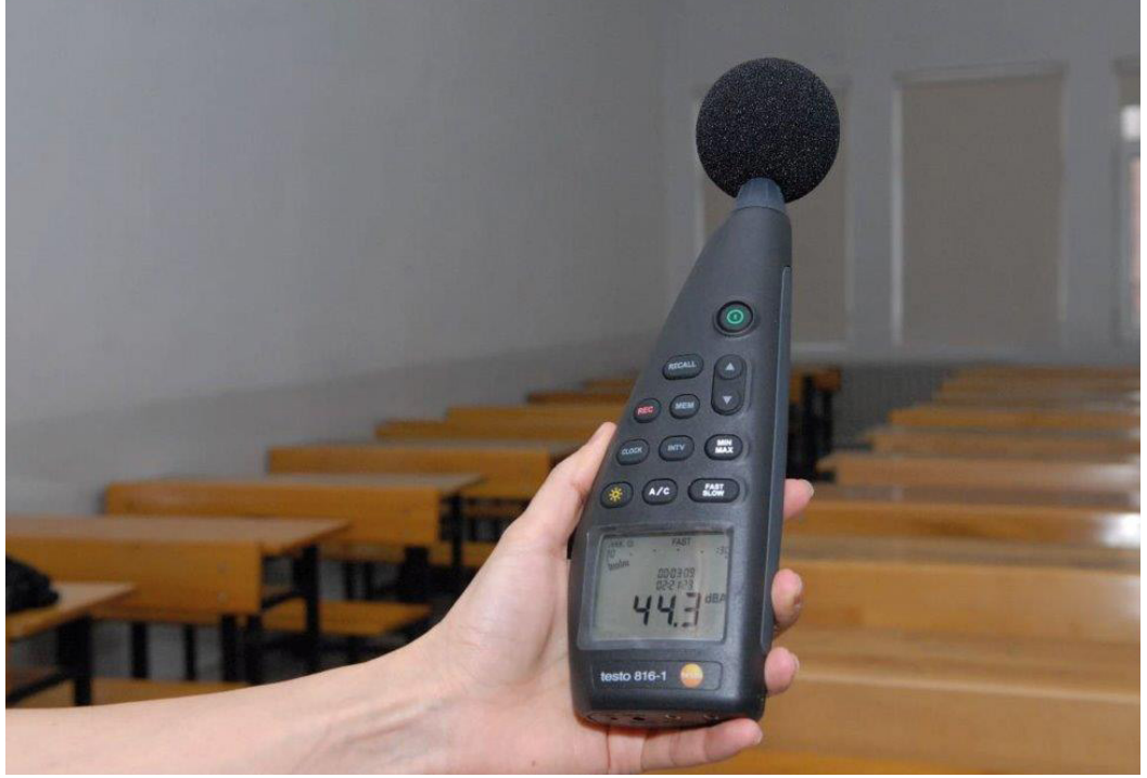
Şekil 13. Gürültü Seviyesi Ölçüm Cihazının Kullanımı
