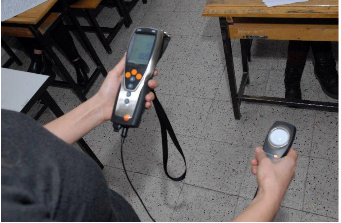
Şekil 9. Işık Ölçer Sensörünün Kullanımı
